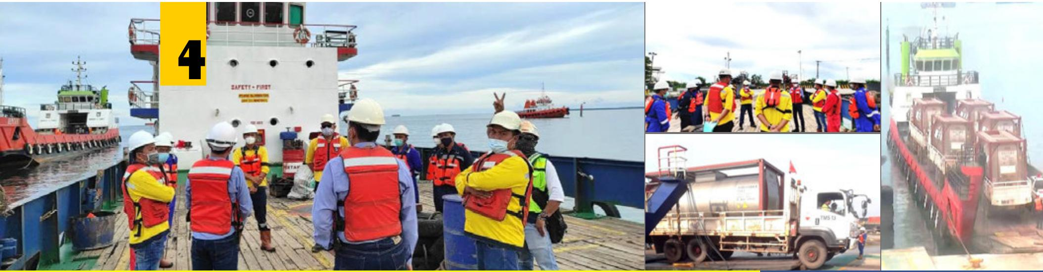
Kegiatan untuk pemindahan cargo dari gudang PT. Kaltim Prima Coal Sangatta ke Bengalon dengan transportasi multimoda seperti Light Truck kapasitas 25 Ton dan LCT Vessel DWT 500 ton. Cargo yang dipindahkan berupa : bahan peledak ANSOL dalam kantung, ISO TANK, aksesoris peledakan, unit alat berat, pupuk, dll.
