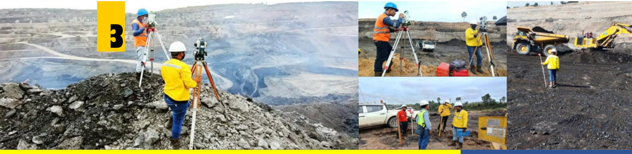
Melakukan join survey sejak tahun 2011 di **Bengalon Coal Project PT. Kaltim Prima Coal**, di mana beroperasi dengan 3 Team dalam melaksanakan Join Survey, termasuk : Pit Void Survey, Coal Roof/ Floor Survey, Top Soil Removal Survey, ROM Survey, Top Soil Stockpile Survey dan juga Rehabilitation Area Survey.
